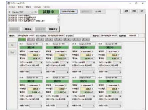
可以一目了然确认每个测量板的数据(8ch)。数据在测量期间实时更新, 并立即转换为数字数据要了解老化的进展。
